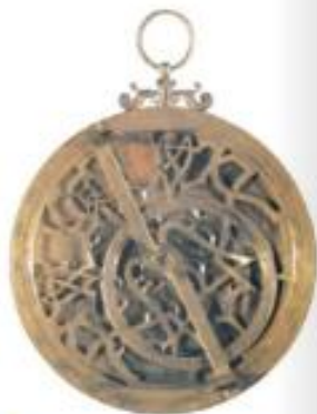
Los grandes descubrimientos geográficos fueron posibles gracias a la generalización de instrumentos de navegación, como el astrolabio , que permitía a los marinos guiarse de noche por las estrellas y navegar sin tener la costa a la vista.
